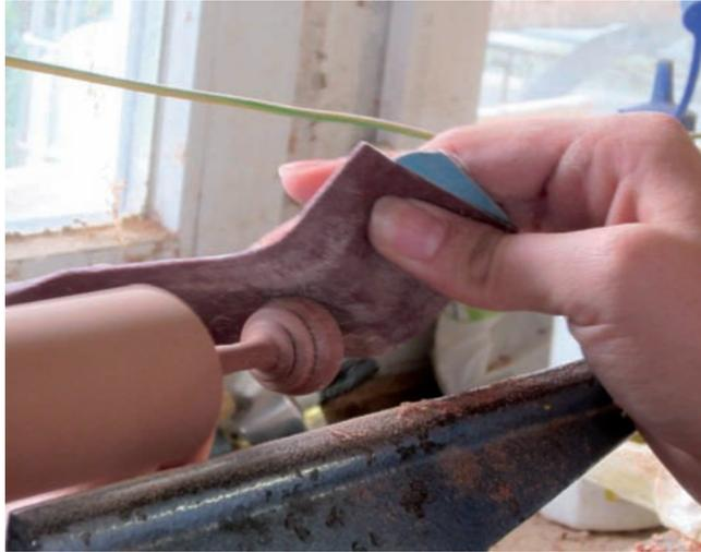
Der Zwirbel ist geformt und wird jetzt fein geschliffen.
