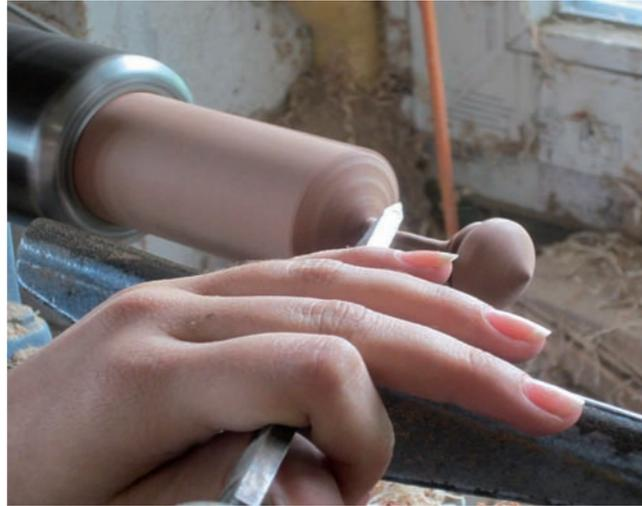
Der fertige Kreisel wird vom Rest-Werkstück abgestochen.
