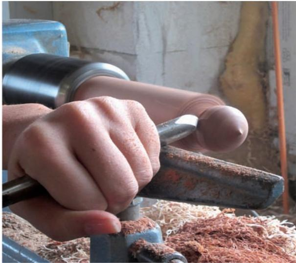
Nach dem Einspannen des Rohlings wird mit ruhiger Hand und mit Einsatz einer feinen Röhre aus dem Rundstab ein Kreisel geformt. Mit einer hohen Drehzal werden die Späne «Dreh» für «Dreh» abgetragen.
