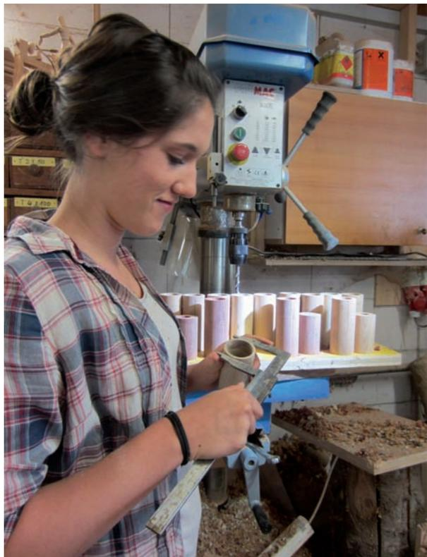
Bei der Arbeit mit der Drehbank wird ein rotierendes Werkstück durch Spanen mit einem scharfkantigen Werkzeug per Hand bearbeitet.
